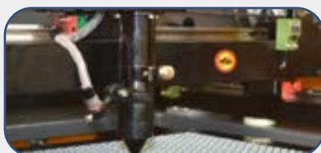
Guías lineales marca HIWIN de máxima calidad, para asegurar un desplazamiento preciso durante el grabado o corte de material.
