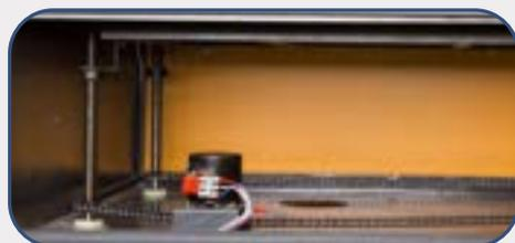
Regulación de altura eléctrica de la mesa de trabajo que permite trabajar con piezas de mayor espesor y regular la posición de trabajo a la distancia focal óptima, en conjunto con el Autofocus.
