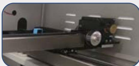
Motores paso a paso Leadshine 57 con mayor torque para asegurar posicionamiento preciso.
